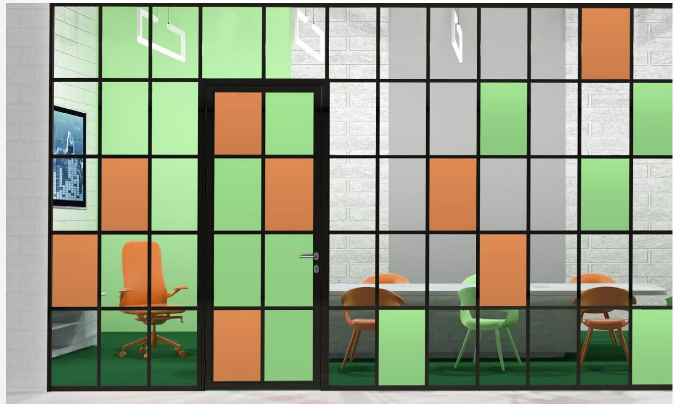
Объемный вариант перегородки в стиле Loft с повышенной шумоизоляцией. В данном случае применяется двойное остекление. Возможна комбинация с непрозрачным заполнением.
