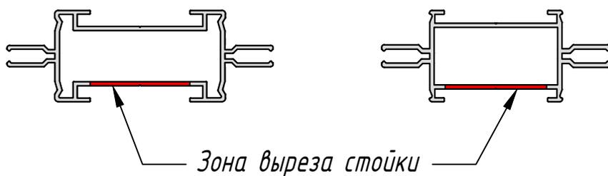
Зона выреза стойки зависит от стороны вывода торсионного механизма
